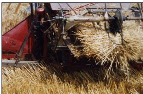
Une faucheuse-lieuse mécanique restaurée par les bénévoles du Musée de la Mémoire Paysanne.
